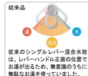
従来のシングルレバー混合水栓は、レバーハンドル正面の位置でお湯が出るため、無意識のうちに無駄なお湯を使っていました。
